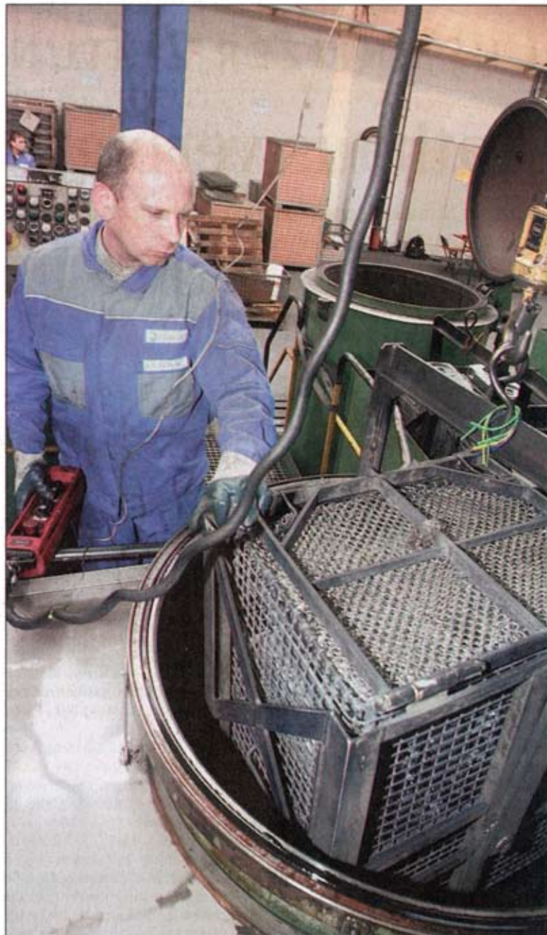
Mitarbeiter Oliver Hoffmann lässt bei der Firma Kitzig einen Korb mit Gussteilen in die Imprägnieranlage hinab. —FOTO: ANDREAS TRUKA
