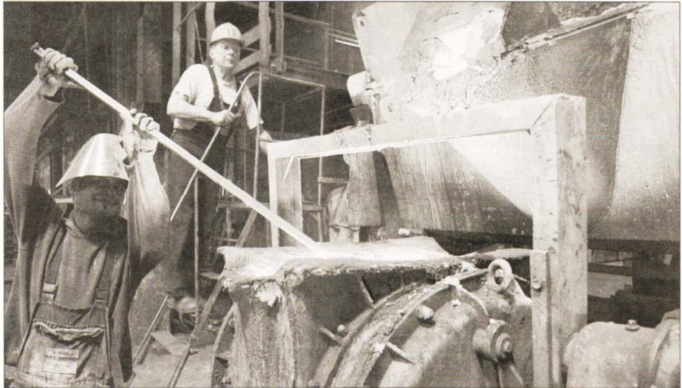
Abstich bei Trompetter Guss in Chemnitz. Das Unternehmen auf dem Gelände des ehemaligen Schönherr Webstuhlbaus hat sich als Zulieferer für den Fahrzeugbau etabliert. Im Bild: Stefan Riedel (vorn) bei der Probeentnahme und Wolfgang Kropp.
